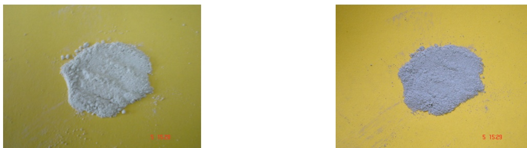
Figura 45. Copolímero Poli(GMA-r-Fc) antes y después de la exposición a la luz ultravioleta.
