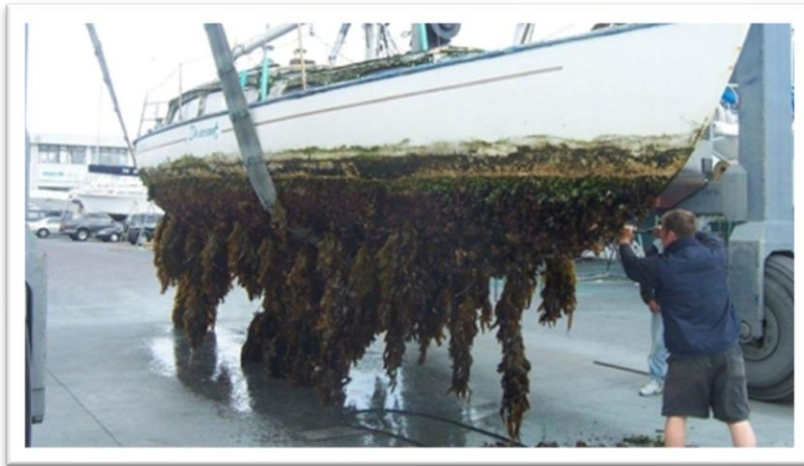
Figura 2: Casco de barco severamente afectado por el crecimiento de algas, requerirá de un mantenimiento correctivo.
