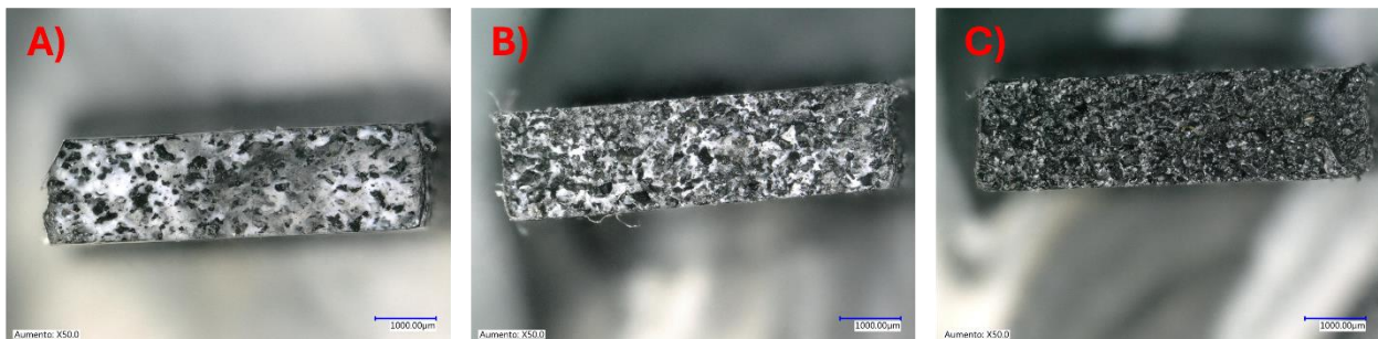
Figura 74. Micrografías a 50 aumentos de las mezclas PP-co-PE con GTR DOH 180/6 a diferentes concentraciones; A) 10%, B) 30% y C) 50%.
