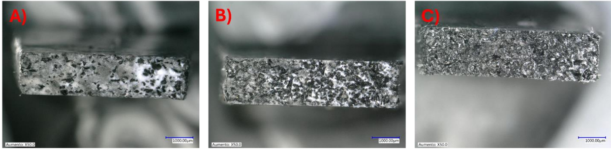
Figura 71. Micrografías a 50 aumentos de las mezclas PP-co-PE con GTR ST a diferentes concentraciones; A) 10%, B) 30% y C) 50%.
