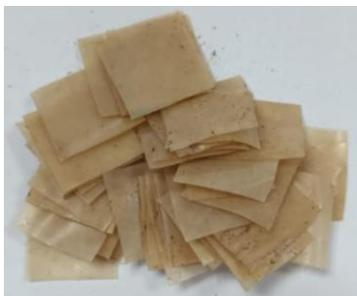
**Figura 48.** Preparación de la prueba de características de biodegradabilidad.
