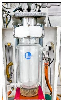
**Figura 7.** Reactor de copolimerización de 600 mL, utilizados en la obtención del copolímero LLDPE y los nanocompuestos MWCNT/LLDPE a diferentes concentraciones de MWCNT.
