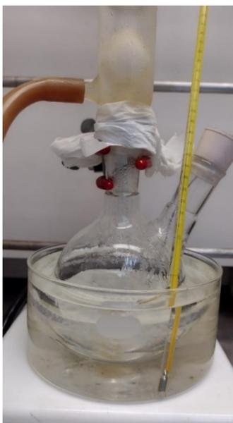
*Figura 24. Montaje del sistema de reacción de copolimerización*
