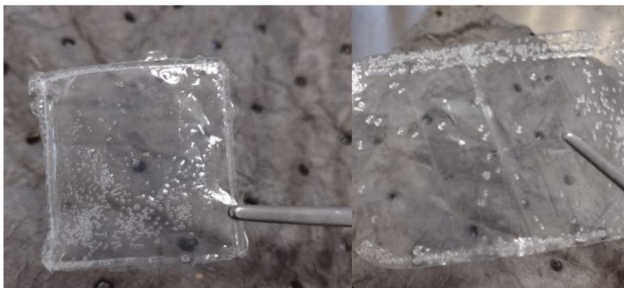
*Figura 57. Marcas superficiales en membranas fabricadas con el disolvente de Acoet y THF.*
