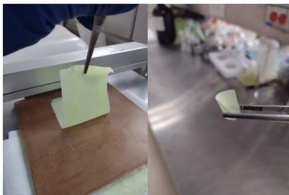
Figura 59. Membrana sSt-co-BuA preparada con THF
