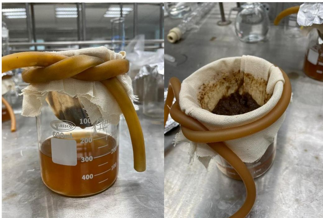
**Figura 5.** Filtrado de la muestra con tela de manta.
