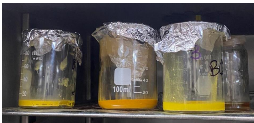
Figura 12.20. Electrolitos LLZTO@PC + PEO/LiTFSI preparados en este trabajo.
