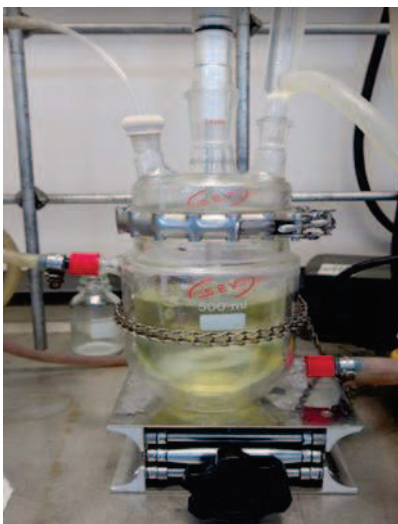
Figura 4. Sistema de reacción empleado para la síntesis del homopolímero (macroRAFT).
