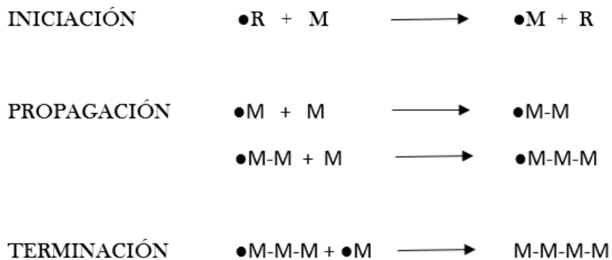
Figura 2. Mecanismo general para sintetizar polímeros por etapas.
