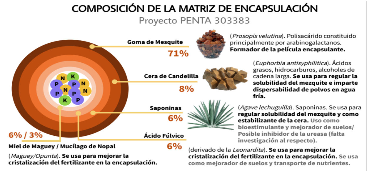
Figura 3. Materiales utilizados como matriz para el encapsulamiento del MKP (fosfato mono potásico).
