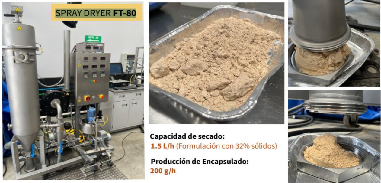
Figura 2. Equipo Spray dryer FT-80 para el encapsulamiento del fertilizante.
