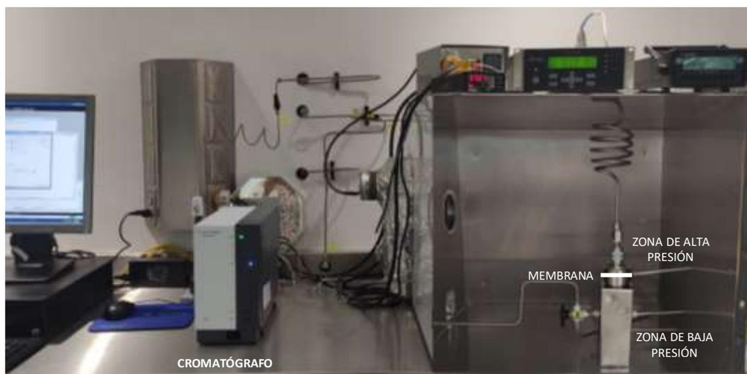
**Figura 21.** Fotografía del dispositivo para ensayos de permeación de gases
