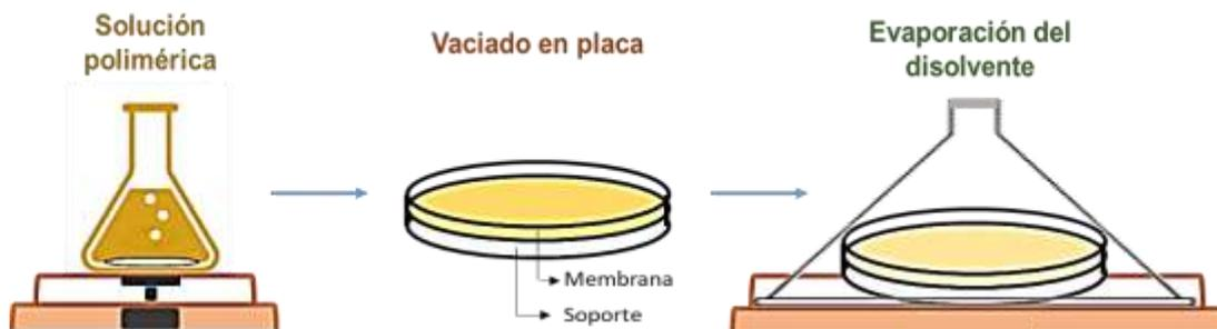
**Figura 18.** Preparación de la membrana compuesta de PEBA mediante vaciado en placa
