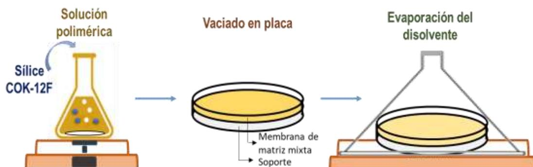
**Figura 20.** Preparación de la membrana de PEBA/COK-12F mediante vaciado en placa
