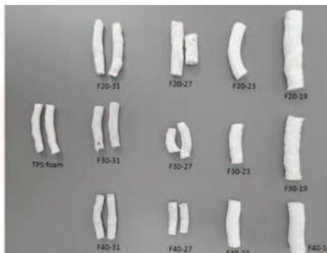
**Figura 13.** Espumas a base de almidón/PVA a diferentes contenidos de PVA (F20, F30, 40) y contenido de plastificante agua/glicerol (31, 27, 23 y 19%) (tomada de Kahvand et al., 2020).
