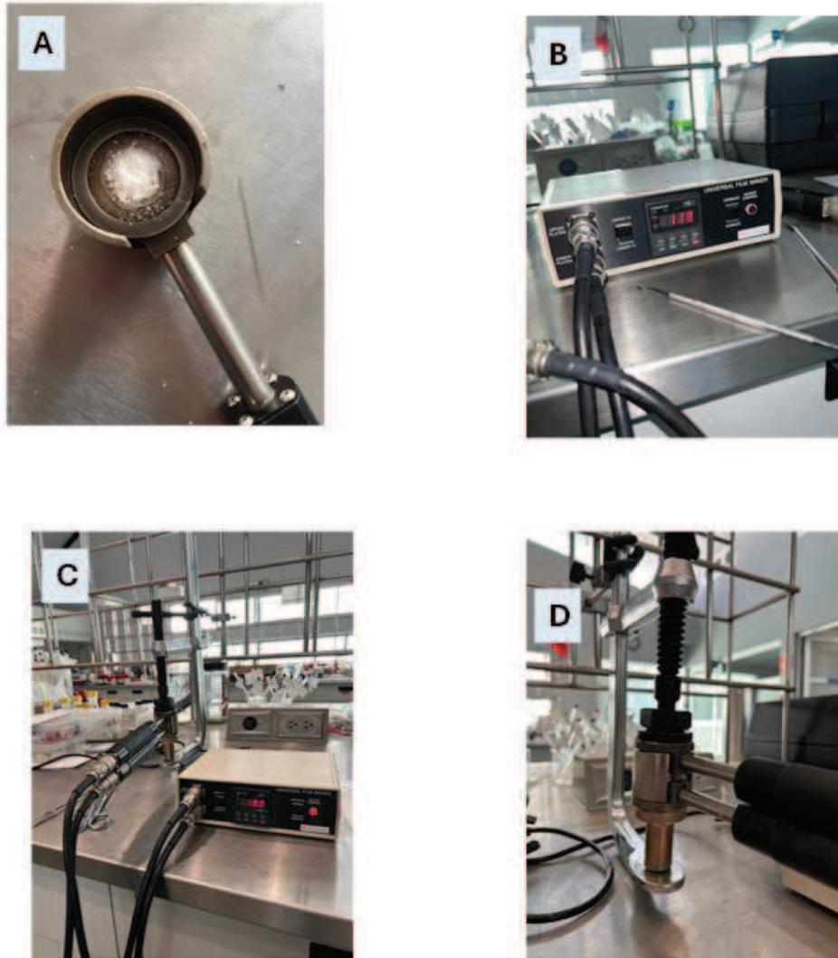
Figura 39. Segregación de fases de los copolímeros mediante el empleo de esfuerzos de corte
