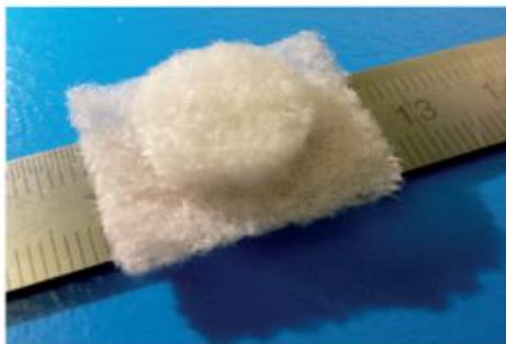
Figura 4.25. Andamios no tejidos en forma de red hechos por electrohilado (Hild et al., 2014).
