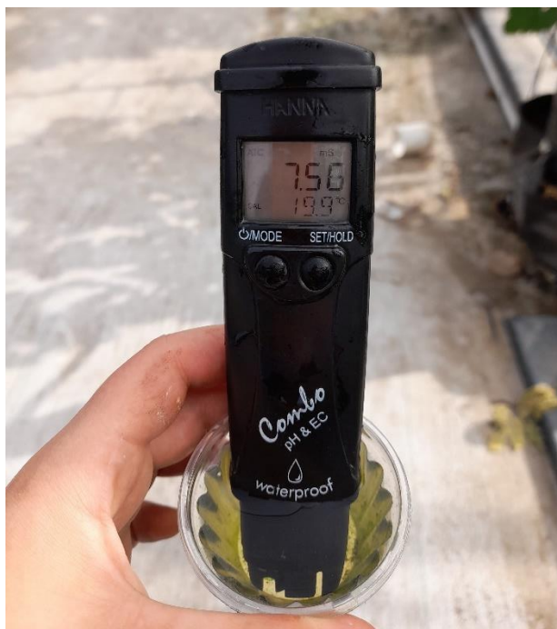
Figura 7. Medición de pH y CE en el agua de drenaje de Ficus carica
