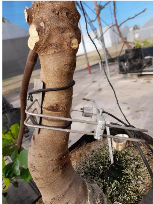
Figura 12. Sensor LVDT instalado en tronco de Ficus carica
