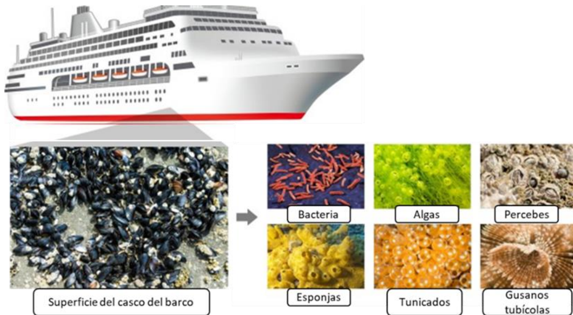
Figura 1. Ilustración esquemática de diferentes organismos incrustantes marinos adheridos a las superficies del casco de los barcos y sus impactos negativos en la industria marina (Jin, 2022) [15].
