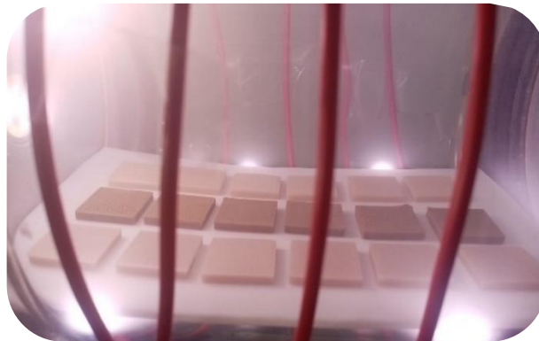
Figura 15. Fotografía de los especímenes impresos para las pruebas de inhibición bacteriana bajo el tratamiento superficial con plasma de argón.
