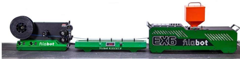
Figura 13. Extrusor empleado para la obtención de filamentos Filabot EX6 Extruder.
