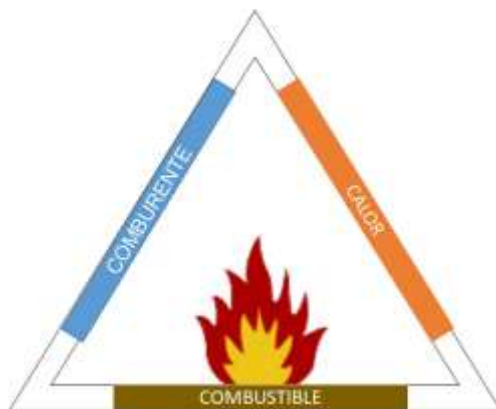
Figura 2.3 El triángulo del fuego que se compone de combustible, comburente y calor.
