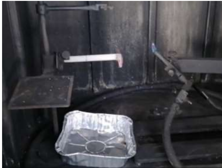
Figura 3.8 Fotografía donde se muestra una probeta de PLA/EVA siendo evaluada bajo las condiciones del ensayo UL-94 HB.
