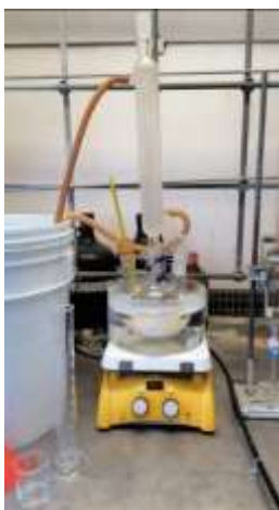
Figura 3.4 Sistema de reacción en el cual se llevó a cabo la encapsulación del sistema retardante a la flama (SRF) de PLG-APP.
