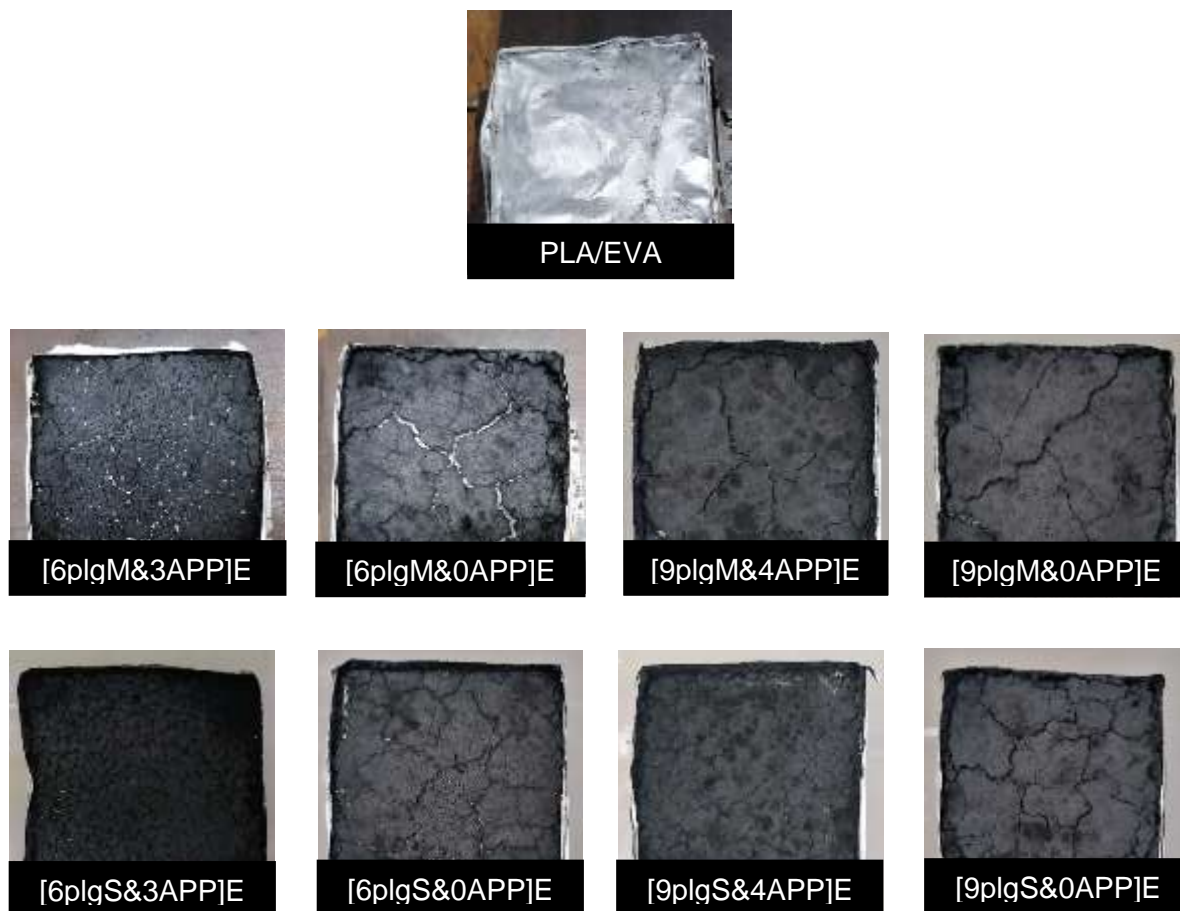
Figura 4.18 Fotografías de los residuos de las 8 formulaciones diseñadas comparándolas contra PLA/EVA sin SRF.
