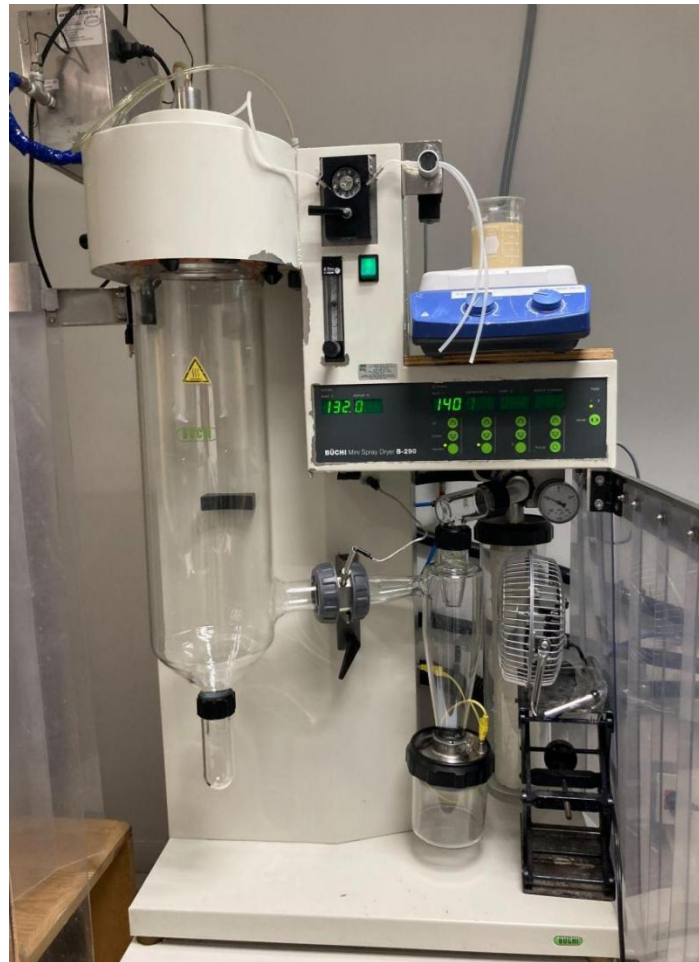
Figura 25 Equipo de secado por atomización, equipo Spray Dryer, Büchi, B-290, ubicado en las instalaciones del Centro de Investigación de Química Aplicada, Saltillo, Coah.
