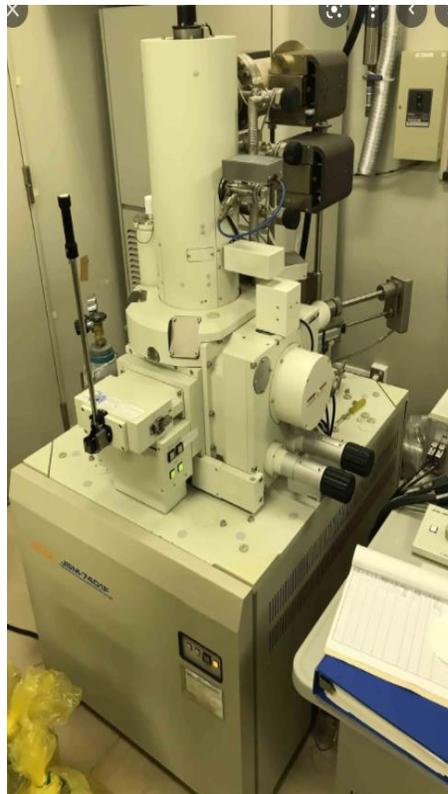
**Figura 24.** Microscopio electrónico de transmisión modelo JEOL JSM-7401F.
