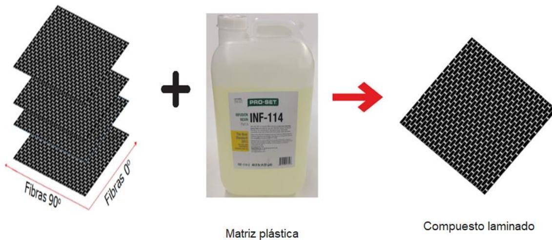
**Figura 2.** Componentes de un compuesto laminado.
