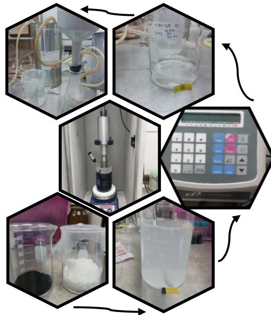
Figura 6.3 Imágenes de procedimiento experimental para experimentos de funcionalización de nanotubos de carbono (MWCNTs) con 8DA mediante energía de ultrasonido.
