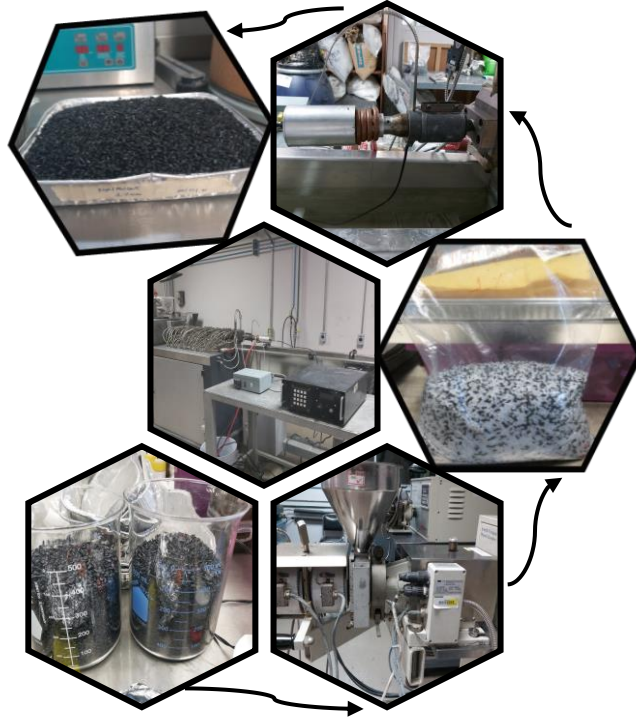
Figura 6.4 Procedimiento experimental para obtener nanocompuesto de Nylon-6 y MWCNTs mediante un sistema de extrusión asistida por ultrasonido.
