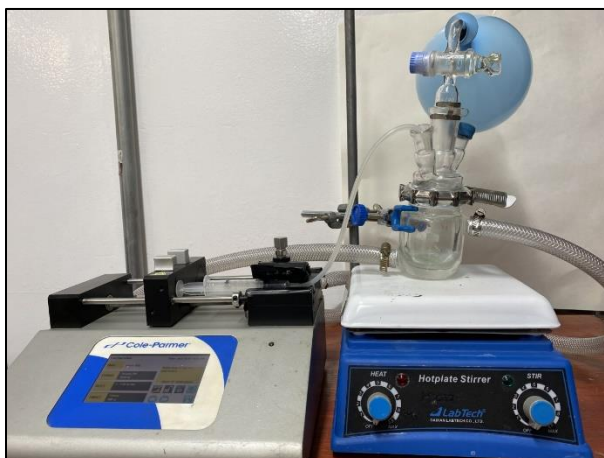
Figura34 Imagen de la bomba dosificadora, parrilla de agitación y reactor encaquetado utilizado para la síntesis de PANI
