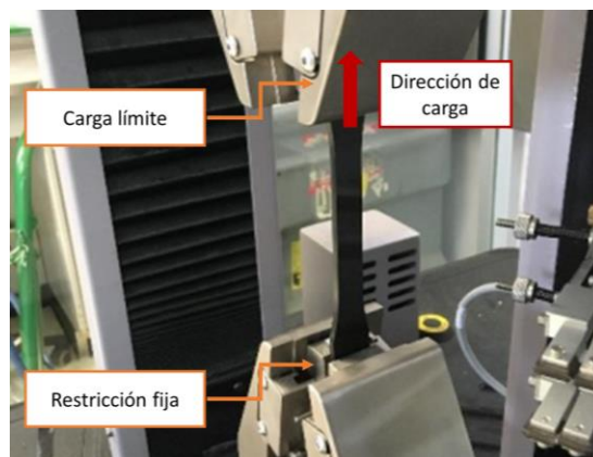
Figura 6.7: Prueba de tensión ASTM D638.
