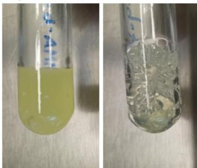
Figura 30. Tubos de reacción a) apariencia homogénea y b) presencia de burbujas por efecto Trommsdorff.
