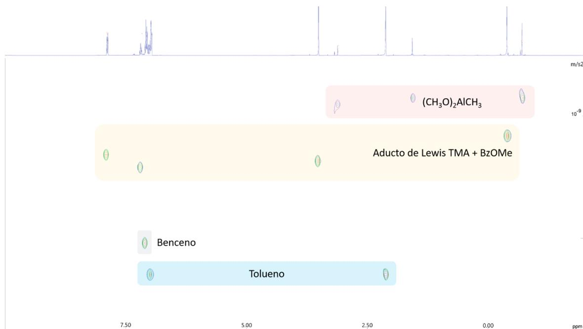
Figura 19. Espectro DOSY-<sup>1</sup>H para la mezcla 1:1 BzOMe y TMA. La franja amarilla agrupa las señales de los dos componentes, TMA y BzOMe difundiendo a una tasa relativamente similar.
