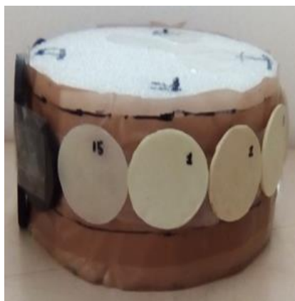
Figura 24. Posicionamiento de las muestras en el dispositivo de PS para el irradiador LGI-1.
