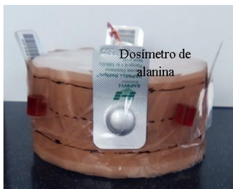
Figura 23. Posicionamiento de los dosímetros en el dispositivo de PS.
