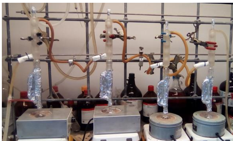
Figura 26. Sistema de extracción soxhlet montado.
