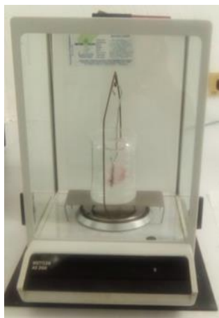
Figura 25. Experimento de densidad por desplazamiento.
