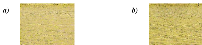
Figura 5.45 Micrografías de películas del copolímero BzclstBzC9OH orientadas por fricción a diferentes velocidades de avance del carro: a) 2 mm/s, b) 10 mm/s
