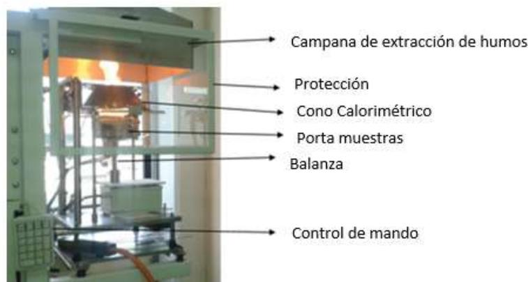
**Figura 44.** Prueba de cono calorimétrico. Cabrera E., *et al.* (2014), Estudio de nanocompuestos a base de polietileno con hidróxido de magnesio e hidrotalcita como retardante de flama. (Tesis doctoral)
