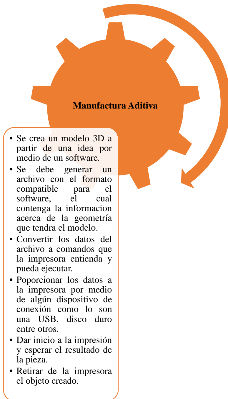
Figura. II.4. Funcionamiento de una impresora 3D
