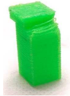
Figura II.12. Desplazamiento de Capas
