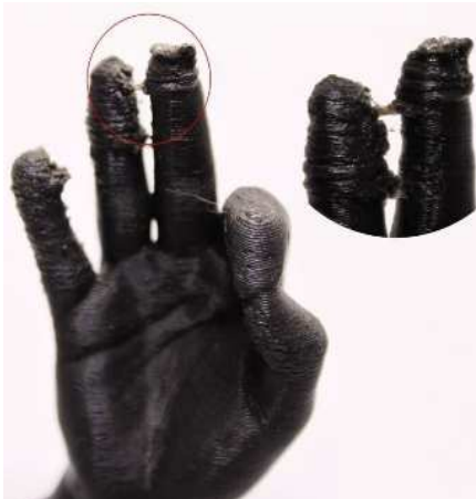
Figura II.11. Temperatura de extrusión muy alta.
