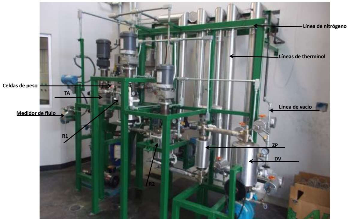
Figura 18. Diagrama de flujo de la PPC para producir HIPS instalada en CIQA
