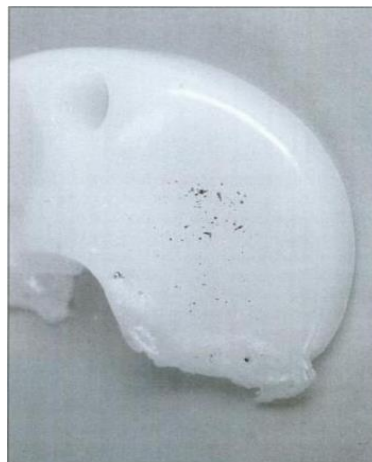
Figura 2.4. Prótesis de polietileno retirado de paciente por desgaste, se puede observar el desgaste en la prótesis y elementos pertenecientes a la prótesis metálica. [19]
