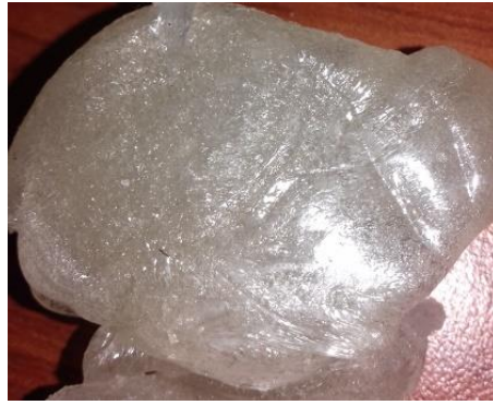
Figura 6.10. Muestra obtenida por lotes mediante mezclado en fundido en equipo tipo Brabender bajo atmosfera de N_2 , procesada a 100 rpm, 160 °C, t=10 min rotores CAM.
