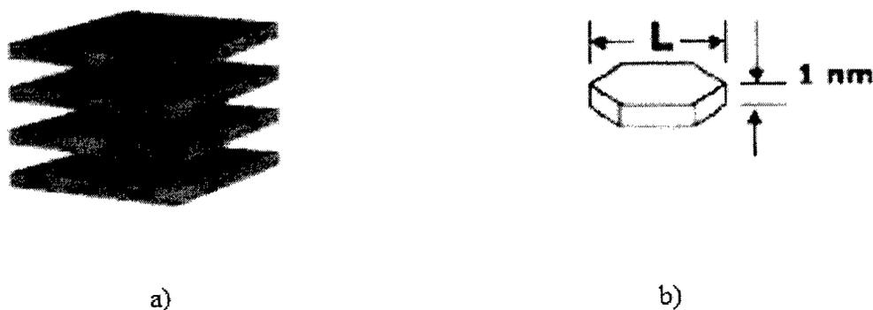
**Figura 2.3** a) Estructura de una arcilla apilada, b) Detalle de una laminilla [16].
