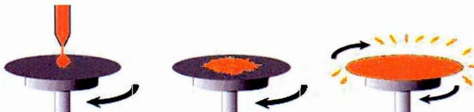
Figura 24. Recubrimiento por Spin Coating.
