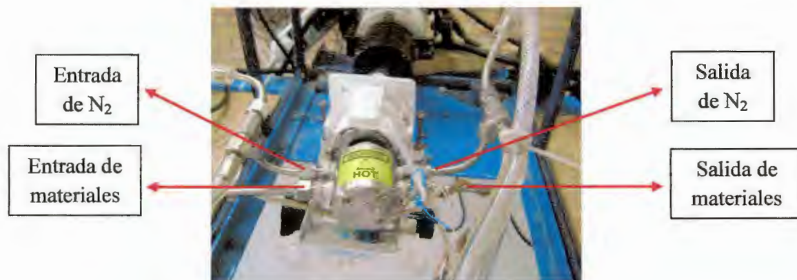
Figura 10. Sistema de bombeo de materiales.
