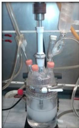
**Figura 11.** Reactor de 5 bocas con chaqueta de vidrio, de 500 ml.
