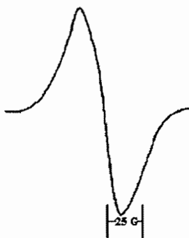
Figura 5.- Espectro de resonancia (EPR) de PVC irradiado
