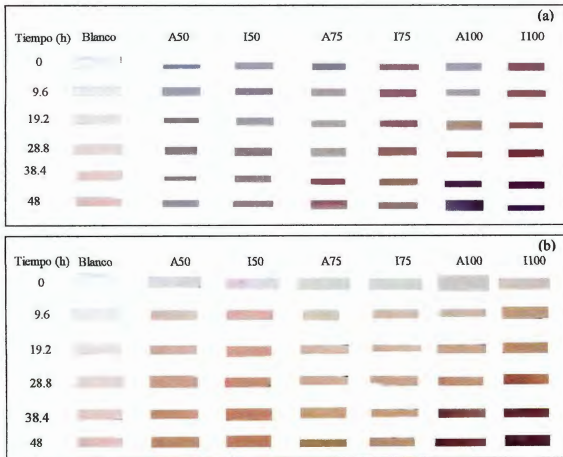
Figura 35.- Formación de color en la formulación PVC + CaZn (2-1) irradiada: (a) TDB y (b) TDA y degradadas térmicamente a 5 diferentes tiempos
