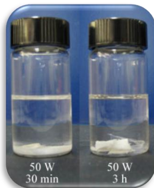
Figura 19a. Efecto del tiempo de tratamiento en la formulación Ca/Zn+ME a 50W
