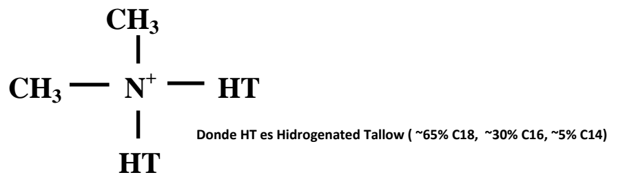
Figura 5.1 Estructura de la Arcilla Cloisite® 20A
