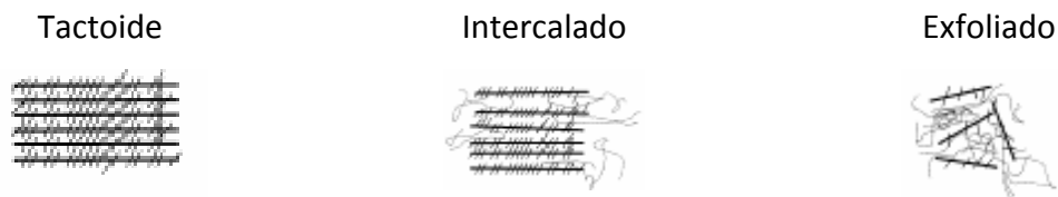
Figura 2.16 Diferentes estados de dispersión de las nanopartículas en un nanocompuesto
