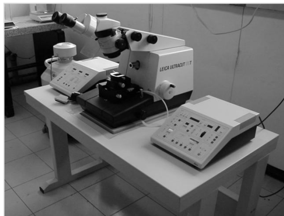
Figura 5.8 Ultramicrotomo Criogénico marca LEICA ULTRACUT
