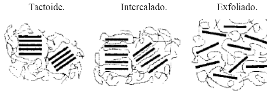
Figura 2.14 Diferentes estados de dispersión de las nanoláminas de arcillas en un nanocompuesto de matriz polimérica.
