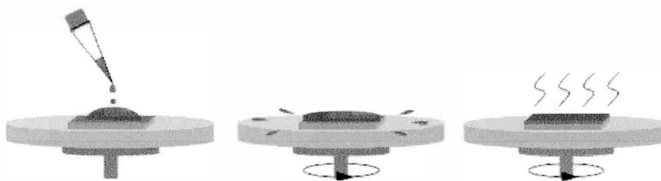
Figura 29.- Técnica de centrifugado a) deposición de la solución en la superficie del sustrato, b) esparcimiento de la solución y c) centrifugado (evaporación del solvente por fuerza centrífuga a las revoluciones por minuto y formación de películas)
