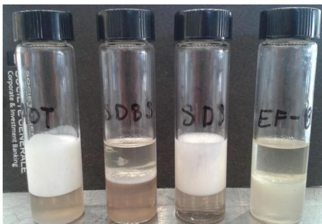
Figura 41. Pruebas estabilidad de emulsión. De izquierda a derecha: AOT, SDBS, SDS y EF-800.
