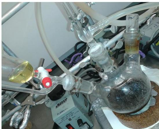
*Figura 5. Sistema de reacción de Grignard, formación de compuesto TMSS.*
