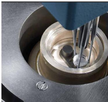
*Figura 7. Colocación de muestra en equipo DSC para medición*
