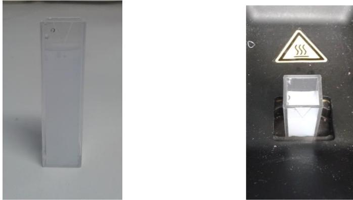
*Figura 6. Cubetas de equipo dispersos de Luz y colocación de las muestras en el equipo.*
