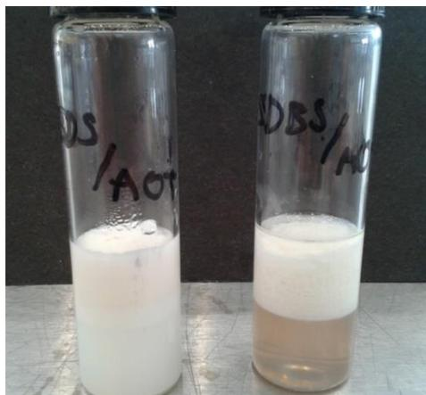
*Figura 43. Pruebas estabilidad de emulsión. De izquierda a derecha: SDS/AOT, SDBS/AOT.*
