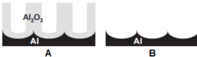
Figura 3.6 Esquema de la sección transversal de una PPA (A) antes y (B) después de la disolución de la capa de alúmina donde se puede observar a los fondos de poros sobre el sustrato de aluminio.
