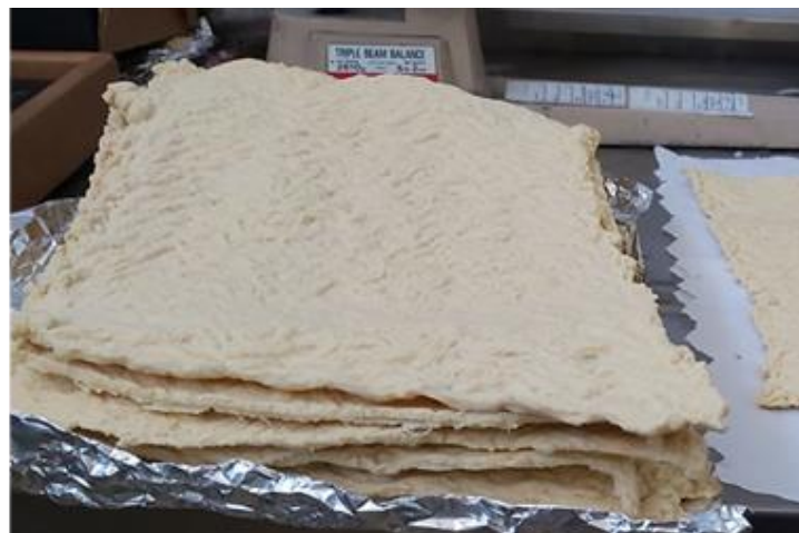
Figura 13. Laminados obtenidos de los compuestos procesados en el molino de rodillos.
