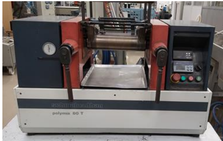
Figura 12. Molino de rodillos utilizado para procesar los compuestos.
