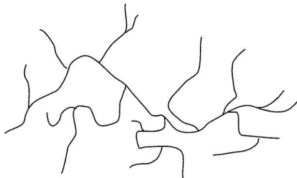
Figura 1. Estructura ramificada del polietileno de baja densidad.
