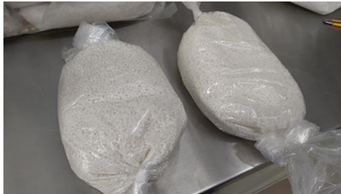
Figura 10. Masterbatch o concentrados de los peróxidos.
