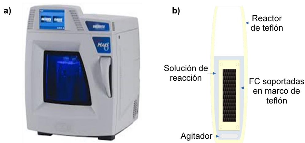
Figura 10. a) Microondas CEM MARS 6. b) FC soportadas dentro del reactor de teflón sumergidas en la solución de reacción.
