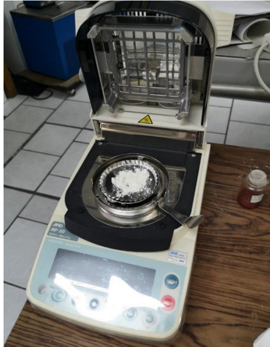
Figura 8.16. Microencapsulados analizados en termobalanza.
