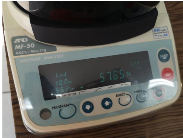
Figura 8.15. Análisis térmico realizado por medio de termobalanza al aceite esencial de cubeb.
