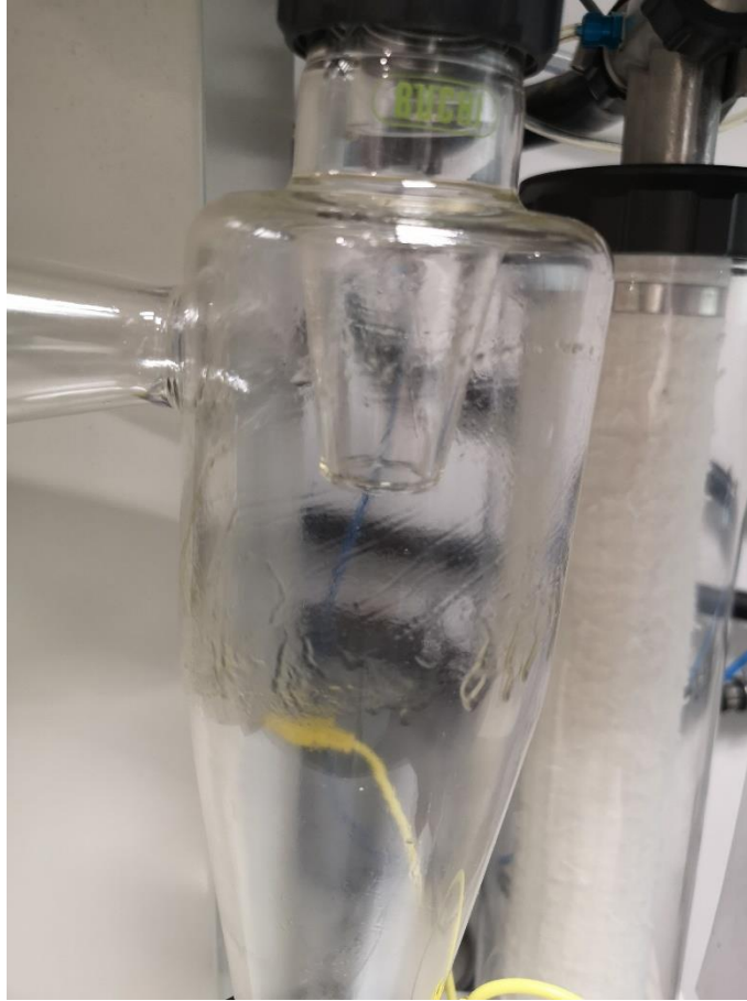
Figura 8.12. Evidencia de sistema no encapsulado, donde se observa aceite en la pared del ciclón colector.
