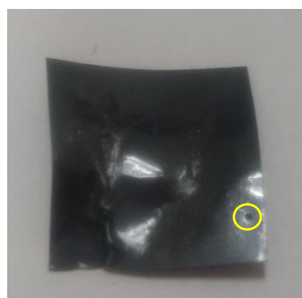
Figura 24. Fotografía de las películas G_Ag (1:0.5) con LIs después de la descarga corona
