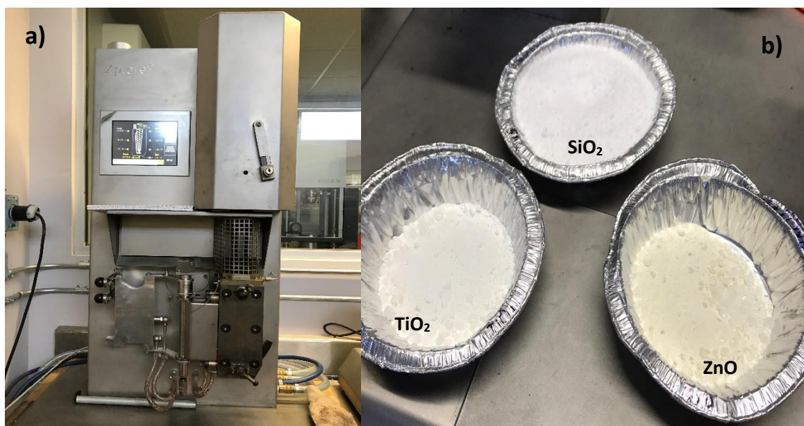
Figura 17. a) Mezclador doble husillo Xplore. b) Mezcla de nanopartículas con LLDPE previo al procesado.
