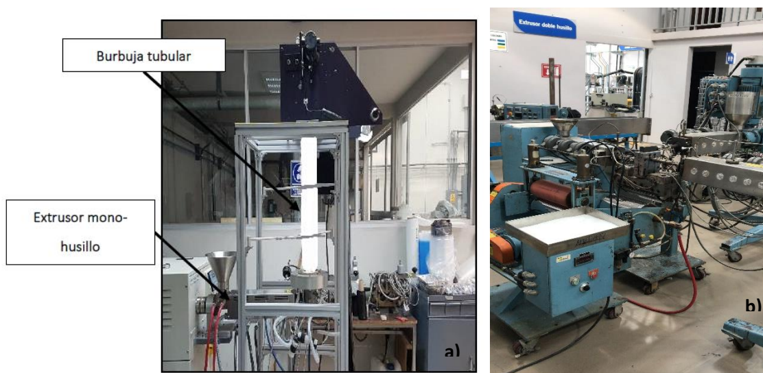
Figura 19. a) Proceso de extrusión de película monocapa soplada. b) Proceso de extrusión de película multicapa plana.
