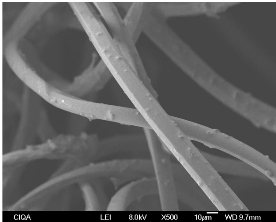
Figura 17. Micrografía venda con hidrogel, AgNPs y grafeno, con líquido iónico
