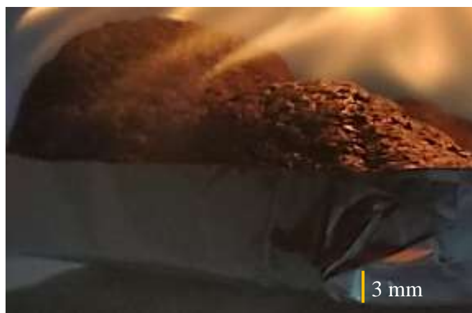
Figura 18. Capa espumada formada por la placa polimérica de 3 mm de espesor compuesta por los tres FR estudiados en calorimetría de cono.
