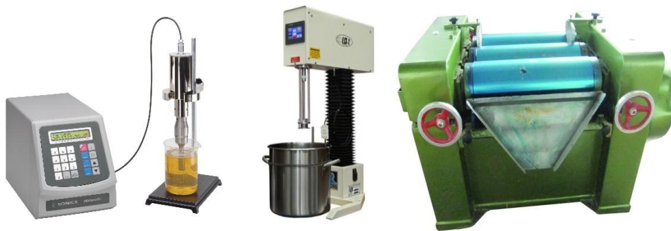
Figura 15. Principales técnicas de dispersión para GNP en resina epoxi, de izquierda a derecha: Sonificador, Mezclador de cizalla, Laminación en tres rodillos
