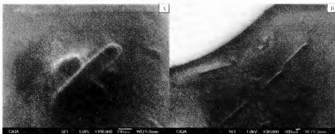
**Figura 6.18.** Imágenes de MEB de los nanocompuestos poliméricos PU-NFC con NFC sin tratamiento.
